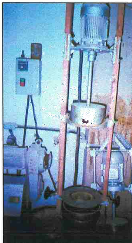
Figura26 – Mistura de PVC e PEAD sendo carregadas triboeletricamente em um recipiente de cobre.
