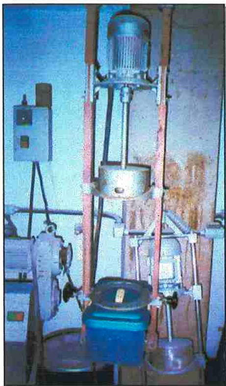
Figura25 – Mistura de PVC e PEAD sendo carregadas triboeletricamente em um recipiente de plástico.
