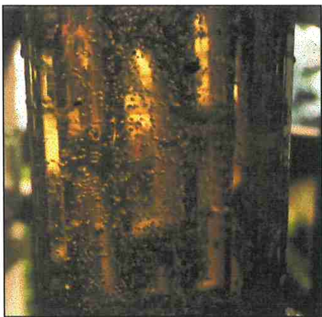
Figura35 – Partículas de PVC capturadas pelas bolhas de ar. No segundo teste também foram utilizadas partículas de 3 mm.
