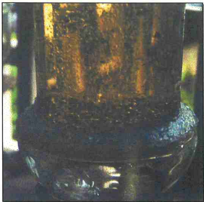
Figura32 – Placa porosa colada ao tubo e bolhas sendo formadas pelo sistema de injeção de ar
