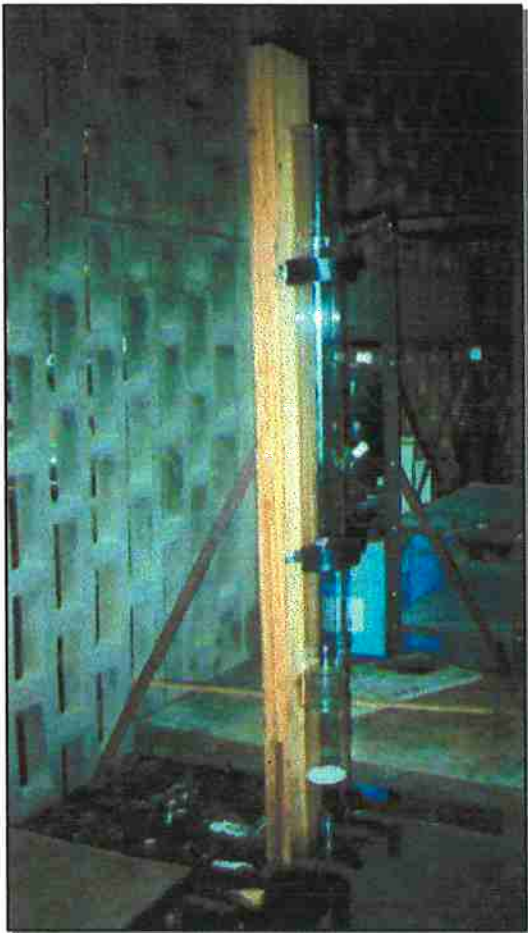
Figura39 – Bancada preparada com suportes presos a mesa e com outro suporte de segurança dotado de um trilho para a parte de baixo do tubo
